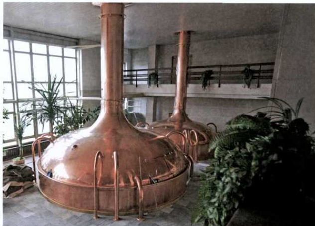
Das Brauhaus mit seinen Kupferpfannen ist das Herzstück der Budweiser Brauerei. Rund 10 Stunden wird das Bier hier in drei Phasen gekocht: Maischen, Läutern, Hopfenkochen.
