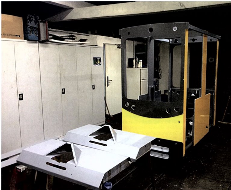
Die neue Dieseldraisine im Zuge der Endmontage. Im Vordergrund die Fahrpulte für die beiden gleichartig aufgebauten Führerstände. Fotos: © Liliputbahn
