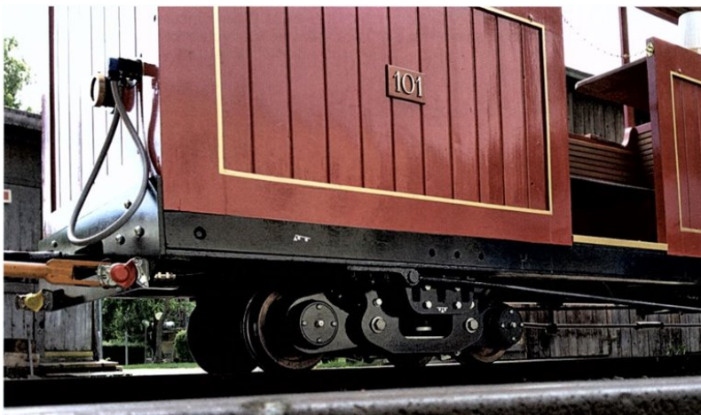
Doppelt gummigefederte Laufdrehgestelle Typ „Sinus“ – eine der Eigenentwicklungen der Liliputbahn.
